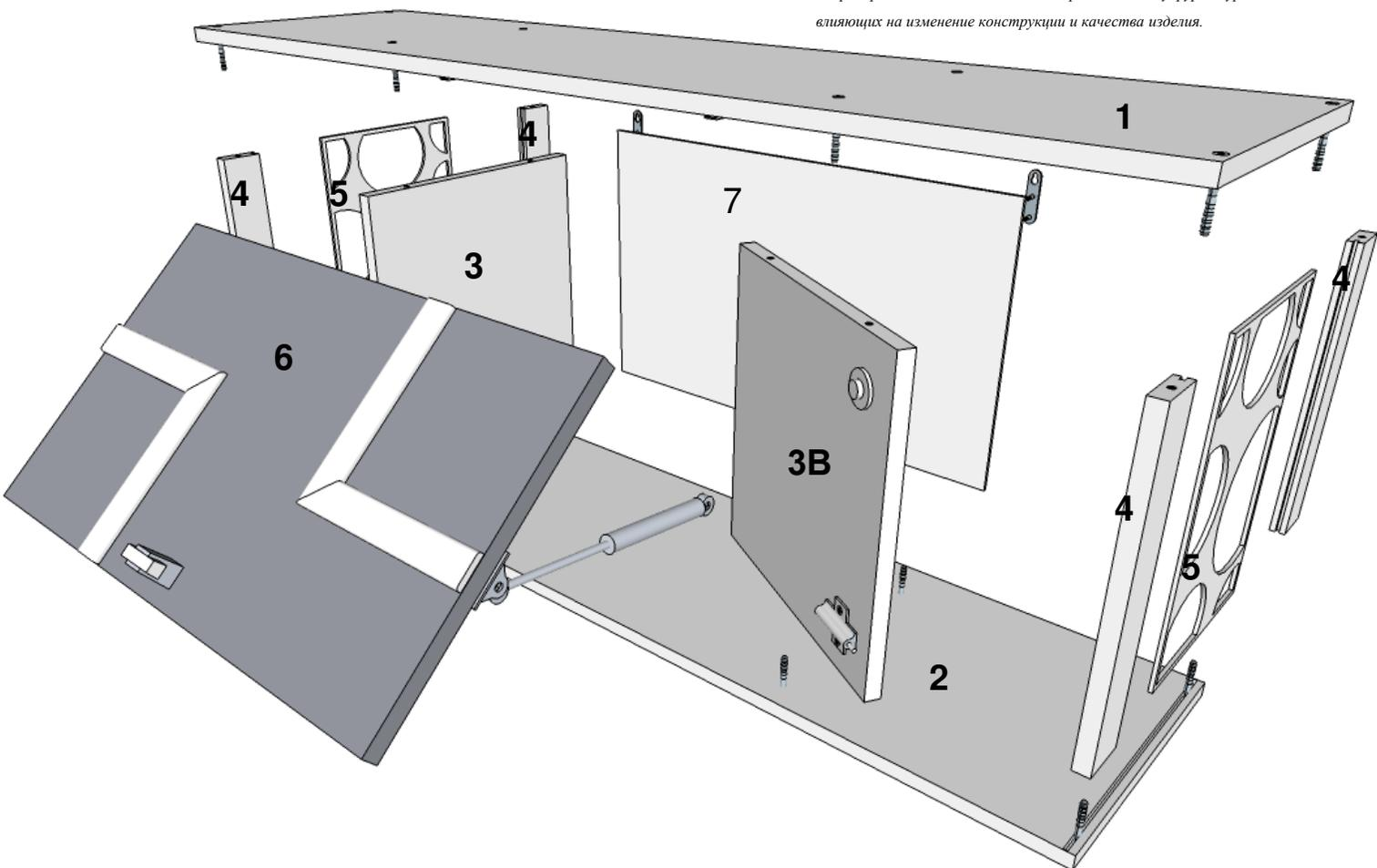
1. На перегородку (поз.3В) установите демфер-упор на шурупы 3\*16.
