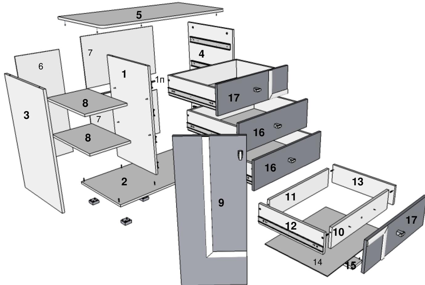
7. Выровняв бока и проверив диагональ, прибейте задние стенки (поз.6,7), задние стенки (поз.7(2)) предварительно соедините профилем (поз.1п).
