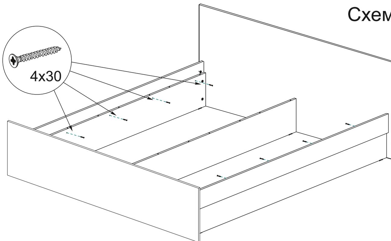
5. После сборки каркаса кровати, для придания конструкции жесткости, соедините между собой царги №5, № 6 и №7 с настилом №1 евровинтами, как показано на схеме 4.
