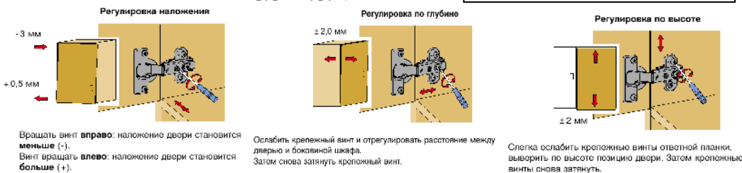
Рис. 3 Схема установки петель
