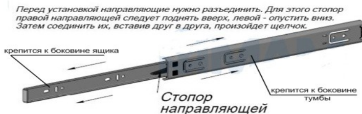
Рис.3 Схема установки шариковых направляющих
