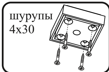
схема монтажа опоры
